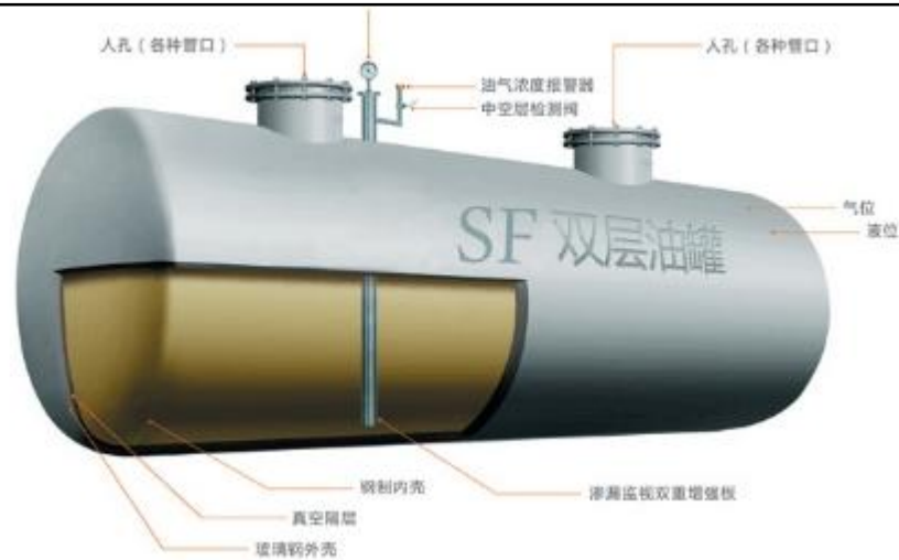
图 2-5 项目所用双层油罐剖面图
